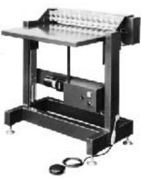
プリント基板の厚み・大きさに関係なく、光電管の検知により、常に一定のレベルで積載する装置です。
