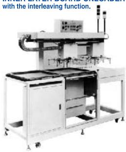
アライメント付自動合紙挿入式受取装置で、 オプションにてAGV対応できます。
