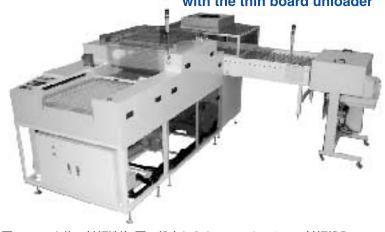
■Auメッキ後の基板洗浄 ■一般室からクリーンルームへの基板投入 ■検査前の基板洗浄 ■外形加工後の洗浄 ■薬液処理後の洗浄乾燥
