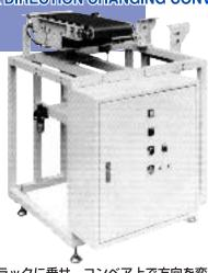
基板をラックに乗せ、コンベア上で方向を変え、次の コンベアに搬送する装置です。
