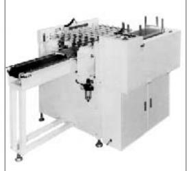
積み重ねられない基板をセットしたラックから、 連続的にコンベア上に投入する装置です。
